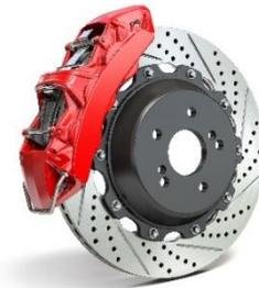
Die Scheibenbremse wandelt die Bewegungsenergie des Autos mithilfe der Reibung in Wärme um. Dazu werden die Bremsbeläge durch einen Kolben im Bremssattel an die Bremsscheibe gedrückt. Diese Reibkraft bremst die Bremsscheibe ab und somit das Rad, das mit ihr festverschraubt ist.<sup>1</sup>
